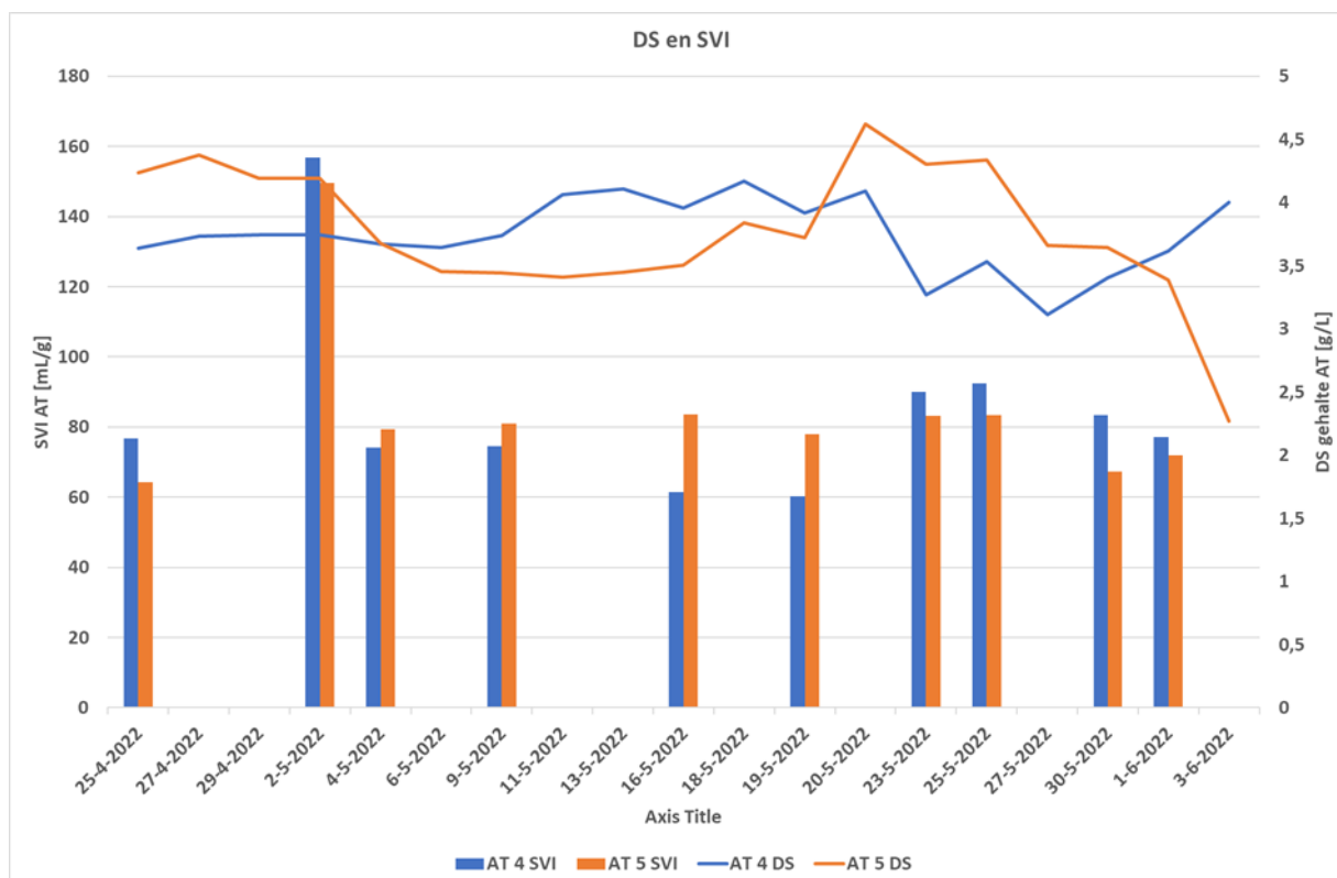
Afbeelding 2. Drogestofgehalte (DS) en slibvolume-index (SVI) in straat 5 (HerCauWer-vlokmiddel) en straat 4 (referentie met commercieel ijzersulfaat)
